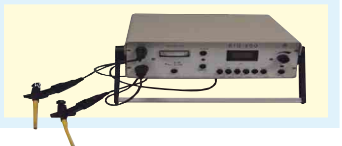
1 Mobiler Niederspannungsstoßgenerator: 6 kV, 1 Ws mit patentierter Fehleranzeige und automatischer Auslösung
