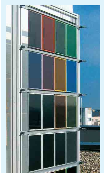
⑧ Mustermodule in Verbundglas-technik mit optisch entkoppelten, farbig strukturierten Deckgläsern und einer Zwischenschicht aus CIS-Dünnschichtsolarzellen.
