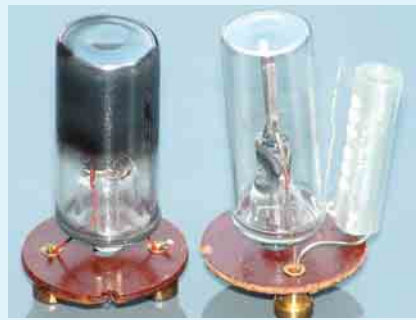
9 „Innenleben“ von Glimmstartern links: gebraucht; rechts: neu mit zusätzlichem Entstör-Kondensator
