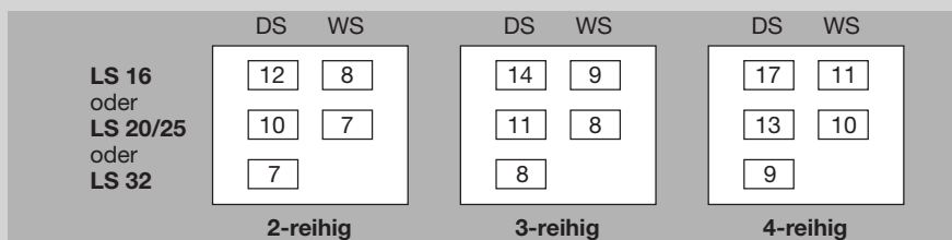
4 Maximale Bestückung von Kleinverteilern [10] für Wandaufbau bei einer Übertemperatur \Delta T = 25 \text{ K} und 20 % Reserveverlustleistung und einem Gleichzeitigkeitsfaktor g = 0,5 . Werte gelten bei Vollbelastung der Abgänge gemäß Tafel 5; für Drehstrom: drei Abgänge pro Stromkreis
