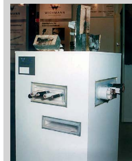
6 Kabelboxen WD90 der Fa. Wichmann sind Stahlblechkästen, die innen mit Brandschutzpaketen ausgekleidet sind. Sie bleiben im Innenraum offen und sind auch für Kunststoff-Panzerrohre bis PG 48 zugelassen. Im Brandfalle schließen die aufquellenden Pakete die Öffnung (oben im Bild).
