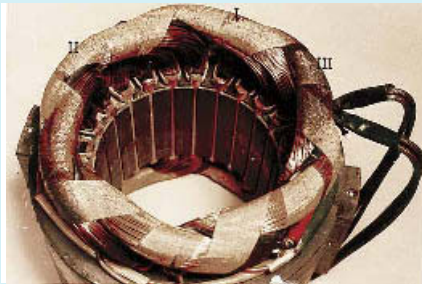
6 Prinzip und Beispiel für das Schadensbild einer 4-poligen Drehstrom-Ständerwicklung nach 2-Leiterbetrieb in Dreieckschaltung (Strang III verbrannt)
