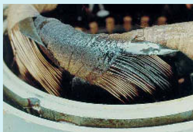
2 Windungsschluss in einem Teil der Spule
