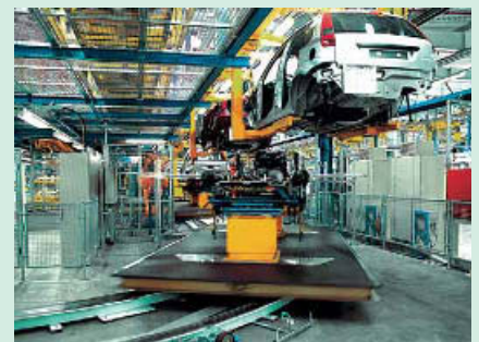
3 Zusammenführung der Karosse auf der Elektrohängebahn mit dem Chassis auf der Plattform
