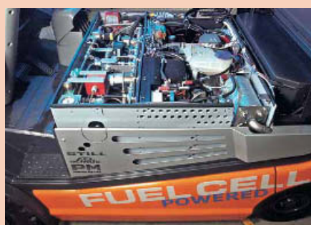
5 Im Batteriefach des Gabelstaplers ist ein komplettes Brennstoffzellensystem mit Wasserstofftechnik und Batteriespeicher untergebracht
