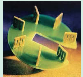
2 Wandlerkopf, bestehend aus mehreren einzelnen Sensor-Leiterplatten sowie einer Basisleiterplatte
