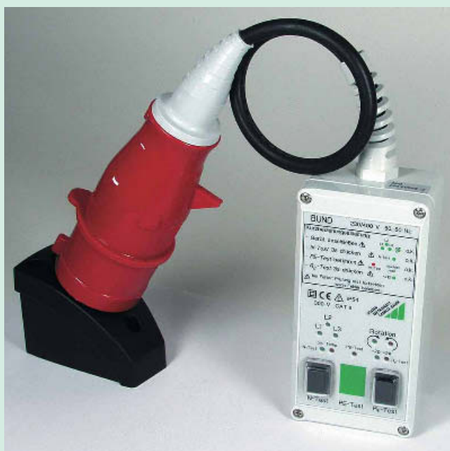
③ Prüfgerät „Bund“ zur Drehfeld- und Neutralleiterkontrolle an CE-Steckdosen 32 A
