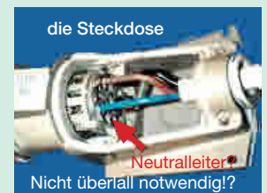
1 CE-Steckdose mit nicht angeschlossenem N-Leiter
