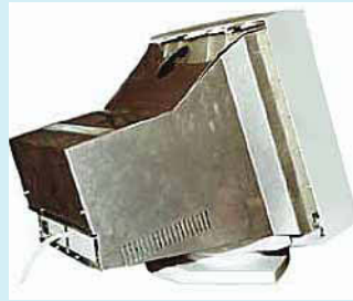
7 Blick in einen Monitor mit Gehäuseabschirmung [11]
