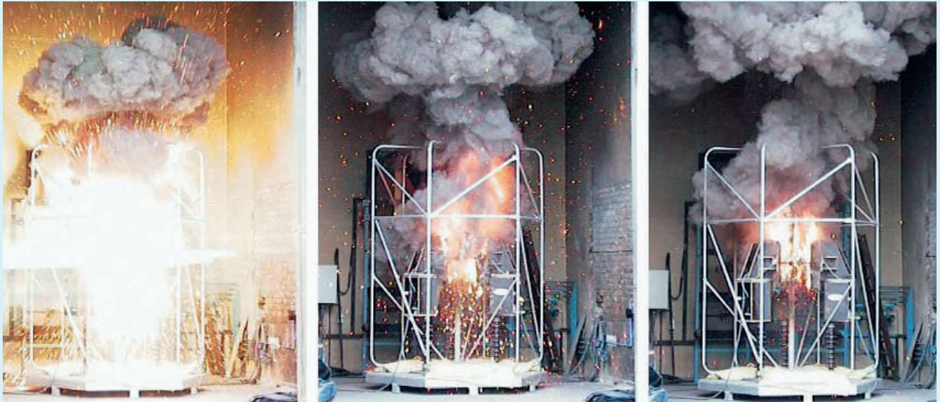
④ Bildfolge aus der Prüfung nach IEC 61482-1, 6 kV, 8 kA, 1 s
