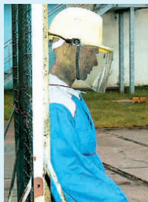
8 Testpuppe vor und nach der Lichtbogenprüfung mit 15 kA, 400 V
