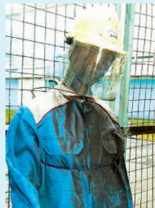
8 Testpuppe vor und nach der Lichtbogenprüfung mit 15 kA, 400 V
