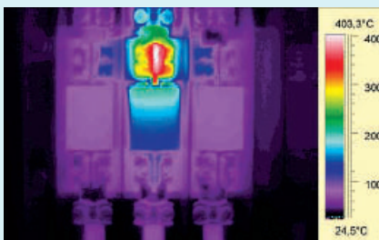
⑧ Klemmkontakt einer NH-Sicherung
