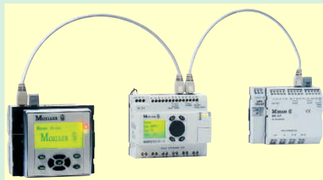
2 Erweiterungsmodule aus der easy-Steuerungsfamilie werden direkt an das Display gesteckt Fotos: Fa. Moeller, Bonn
