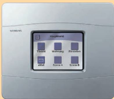
3 Beim Touch-Manager wave werden Internet-Technologien zur Steuerung der Elektroinstallation genutzt
