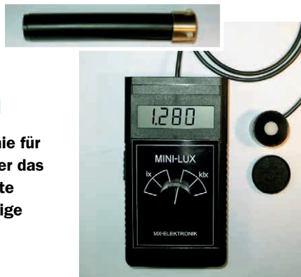
1 Digitalluxmeter „MINILUX“ Fotoelement (über Messleitung verbunden) Vorsatz für Leuchtdichtemessung (Tubus, oben im Bild) Quelle: www.mx-electronic.com
