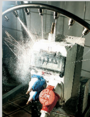
② Staubschutzprüfung nach DIN EN 60529 mit Talkumpuder in der Staubkammer (links) und Feuchtigkeits- und Wasserschutzprüfung (rechts)
