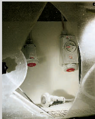
② Staubschutzprüfung nach DIN EN 60529 mit Talkumpuder in der Staubkammer (links) und Feuchtigkeits- und Wasserschutzprüfung (rechts)
