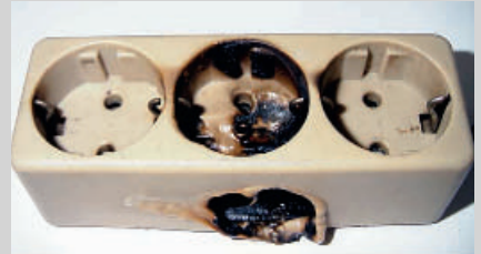
4 Verschmorte ortsveränderliche Mehrfachsteckdosenleiste
