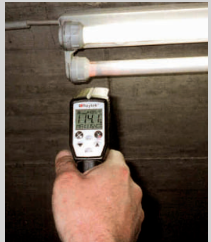
5 Im Dauereinschaltzustand befindliche L-Lampe
