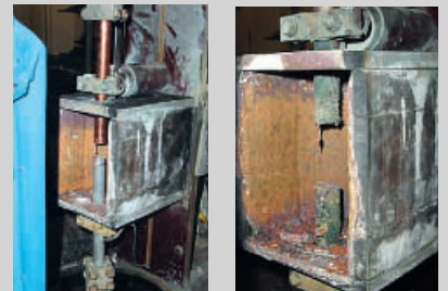
2 Infolge der Störlichtbogeneinwirkung sind die Elektroden der rechten Prüfbox gleich mehrere Zentimeter abgeschmolzen
