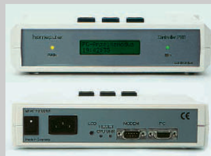
2 Zentrale Steuereinheit: An der Rückseite befinden sich Anschlüsse für PC, Modem und 230-V-Versorgung
