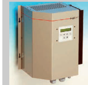
7 Managementsystem für Parallel- und Inselbetrieb mit einer variablen Leistung bis zu 4,6 kVA bei einphasiger Einspeisung mit integrierter Schutzeinrichtung und Möglichkeiten der Bedienung vor Ort über Display oder Fernbedienung. Foto: Humboldt-Lotz
