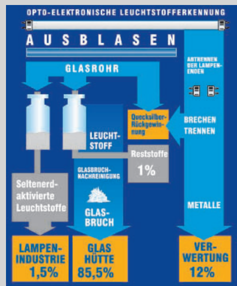
① Recycling von Leuchtstofflampen
