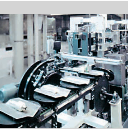
③ Automatische Recycling-anlage für Kompakt-Leuchtstofflampen Quelle: WEREC
