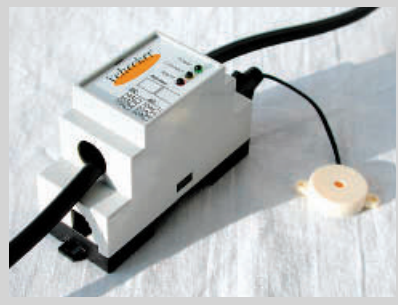
3 Der i'checker misst den produzierten Strom und gibt Alarm, wenn 24 Stunden keine Erträge zu verzeichnen sind. Foto: Meteocontrol
