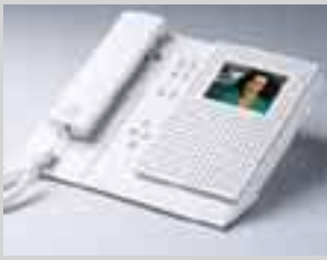
② Doppelnutzung: Der Monitor zeigt das Bild der Türkamera und dient als Touchscreen zur Bedienung des Systems
