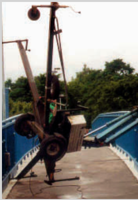
❶ Durch unvollständige Abstützung der Arbeitsbühne stürzte der Monteur aus 9 m Höhe
