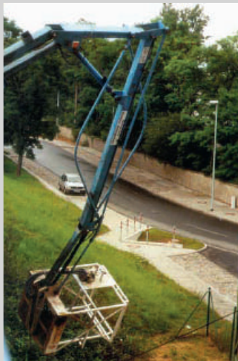
❶ Durch unvollständige Abstützung der Arbeitsbühne stürzte der Monteur aus 9 m Höhe
