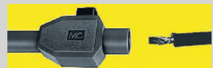
7 Messleitungsadapter mit vollständigem Berührungsschutz zur Aufnahme von mehrdrähtigen Leitern – die Kontaktierung erfolgt über eine per Drucktaste zu entriegelnde Trompetenöffnung
