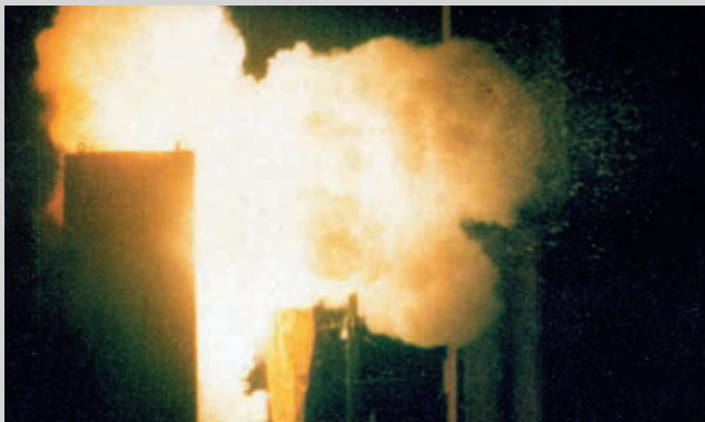
❶ Störlichtbogen bei der Anwesenheit einer Person (Dummy) an einer geöffneten NS-Schaltgerätekombination Foto: IPH Berlin
