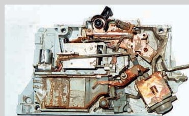
8 Häufig zu beobachten war, dass die Schutzeinrichtungen der überfluteten Anlagen nicht ansprachen, das Wasser durch die Elektroenergie erhitzt und die Kunststoffteile beschädigt wurden
