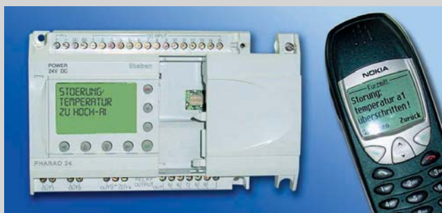
❶ Die Kleinststeuerung kann auch über die Mobilfunknetze kommunizieren und SMS-Nachrichten versenden
