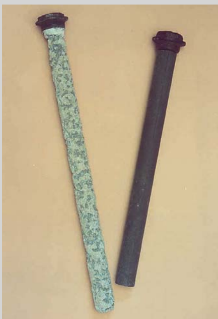
4 Magnesiumschanoden für emaillierte Stahlbehälter links: nach längerer Betriebszeit rechts: ungebrauchte Schutzanode
