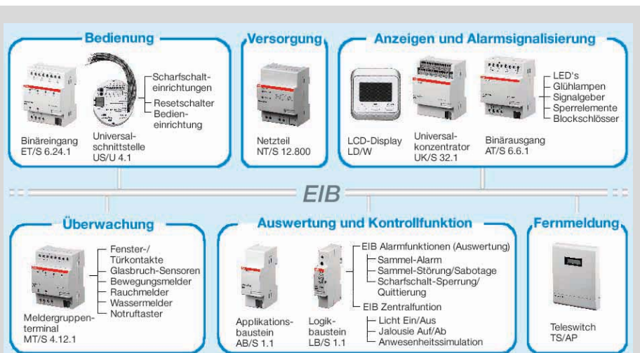
3 Alarmanlage mit „generischen“ EIB-Geräten
