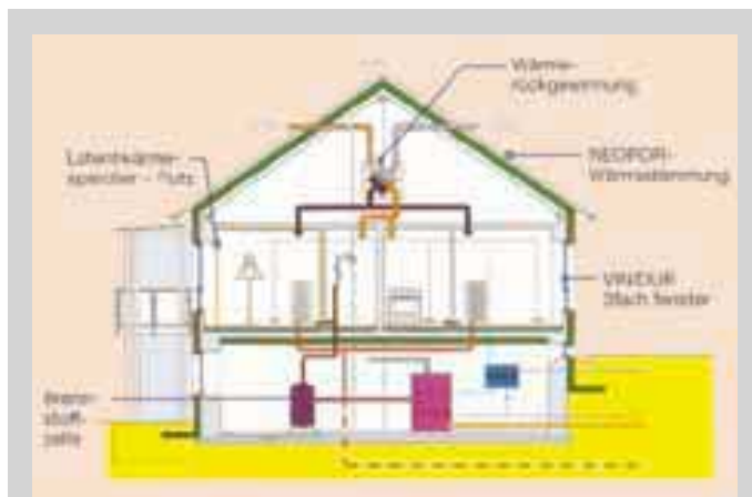
① Zu den Innovationen des sanierten Typ-3-Liter-Heizöl-Mehrfamilienhauses (pro m 3 ) zählt auch eine Brennstoffzelle. Quelle: BASF
