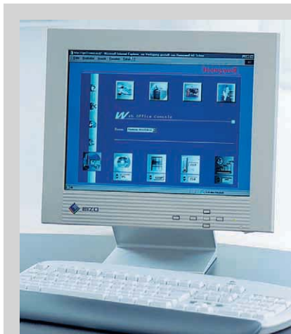
② Mit der Web Office Console lassen sich individuelle Raumbedingungen vom Büro-PC aus verändern
