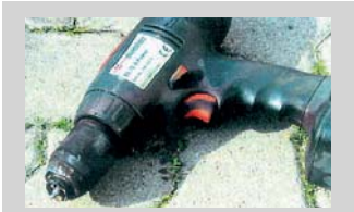
➊ Akkuschrauber nach dem Störlichtbogenunfall
