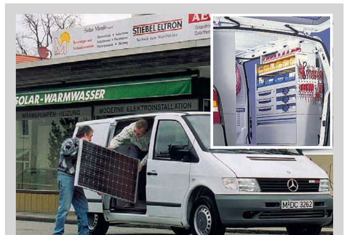
1 Speziell für das Elektrohandwerk als „rollende Werkstatt“ angebotener Transporter
