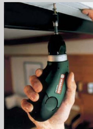
3 Der Schrauber im Mini-format wiegt samt Akku nur 600 g
