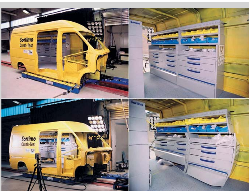
1 Ein Sprinter von Mercedes Benz mit einer Fahrzeugausrüstung der Fa. Sortimo im Crashtest beim TÜV Deutschland. Mit 380 kg Fahrzeugeinrichtung und 600 kg Beladung prallte das Fahrzeug mit 33,79 km/h auf. Ergebnis der Tests: es bestand zu keiner Zeit eine Gefahr für die Insassen.
