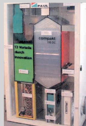
3 Wärmepumpen-Kompaktgerät zur Lüftung, Wärme- und Warmwasserversorgung von Passivhäusern. Im Gerät befindet sich ein Wärmetauscher, der laut Hersteller der Frischluft bis zu 99 % der Abwärme zuführt. Abmessungen: 1816x1106x528 mm.
