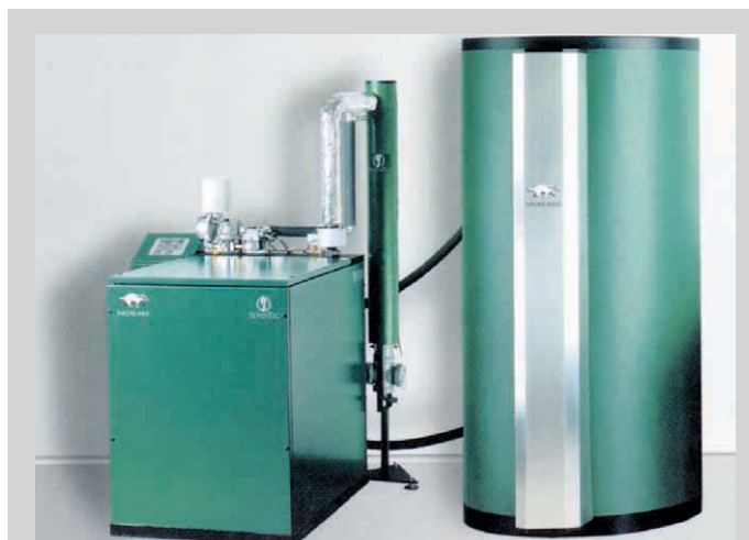
1 Energiezentrale für 5,5 kWel und 12,5 - 20 kWth, bestehend aus der Heizkraftanlage (BHKW, Grundfläche 1 m²), einem Wärmespeicher und einem Warmwasser-Modul.
