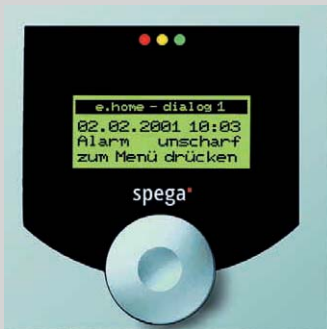
4 Mit dem zentralen Bediengerät „e.home dialog 1“ lassen sich physikalische Größen anzeigen und alle Verbraucher manuell oder über Zeitschaltuhren steuern
