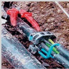
① Halb verschraubte Kompaktklemme, die zu einem tödlichen Stromunfall führte
