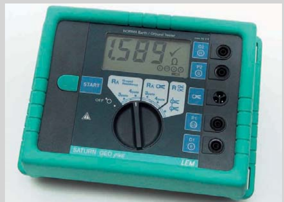
3 Der „Saturn Geo plus“ ist ein Ein-Tasten-Erdungsmesser
