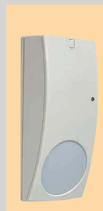
3 Erkennt Freund und Feind: mit einem speziellen Spiegelsystem detektiert dieser Melder Haustiere. Leider gibt es diesen Melder nur in der Schutzart IP 41
