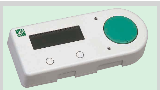
1 Die zentrale Displayeinheit comfort dient der optischen und akustischen Anzeige der im System ausgelösten Rufe. Weiterhin werden die Anwesenheitsmeldungen des Pflegepersonals im Patientenzimmer angezeigt
