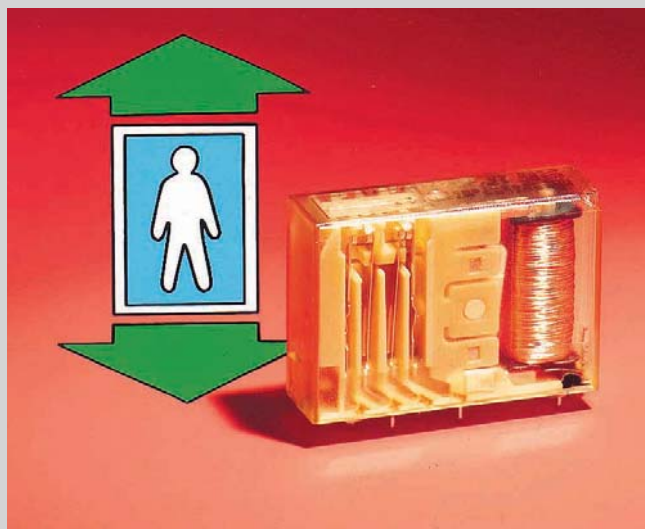
❶ Relais mit zwangsgeführtem Kontaktsatz – hier ein Modell der Fa. Hengstler – ermöglichen Sicherheitssysteme, die im Fehlerfall ein eindeutig vorhersehbares Verhalten haben Foto: Hengstler
