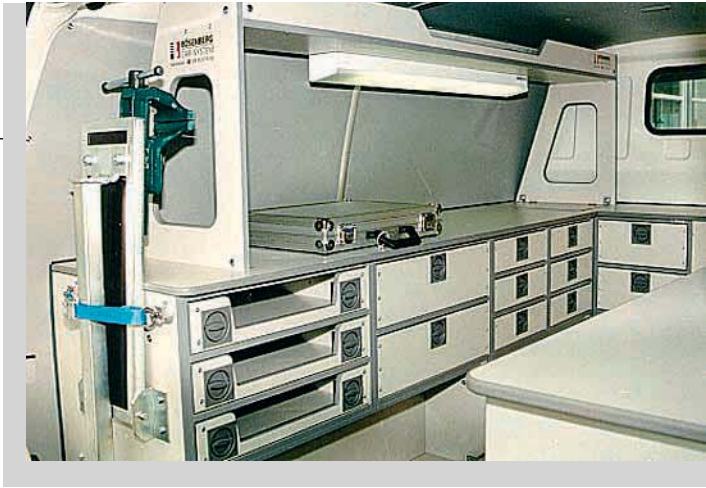
❶ Das Car-System von Bösenberg hat Elemente aus kunststoffbeschichteten Holzwerkstoffen
