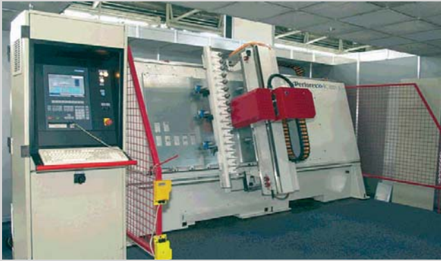
② Bearbeitungszentrum mit Vierachsen-CNC-Steuerung – die Perforex BC2001S von Kiesling
