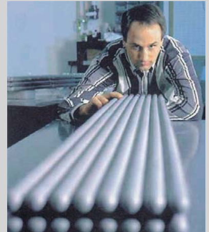
6 Nicht viel dicker als Besenstiele sind die 1,50 m langen SOFC-Röhren der 1. Generation (Foto: Siemens-Westinghouse)
