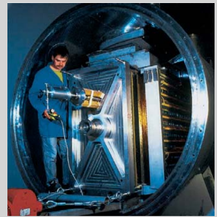
4 Stahlkessel mit 300 in Reihe geschalteten großflächigen, scheibenförmigen BZ-Kernelement des HotModule (im Vordergrund ist die Spanneinrichtung erkennbar) (Bilder: MTU)
