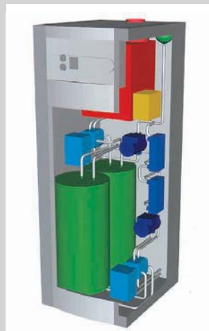
1 Kernstück der gasbetriebenen Zeolith-WP sind zwei gleiche WP-Module. Das Ziel ist die CO 2 -Emissionsminderung um 20 % gegenüber dem Spitzenreiter Brennwerttechnik.
