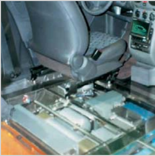
③ Unter den Sitzen des Nocar 5 angeordnetes komplettes Antriebssystem
