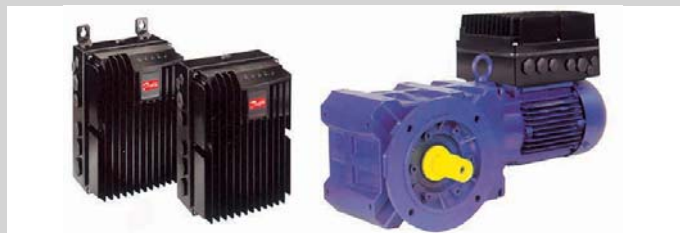
⑦ Getriebemotor mit Umrichter, 0,09 bis 0,75 kW, Schutzart IP 65, Elektronikteil motor- oder wandmontierbar Foto: Danfoss
